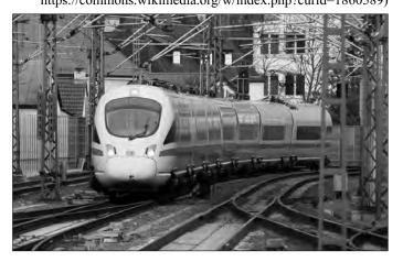
schnelle(re)n Durchfahren von Gleisbögen geneigt werden können. Durch das Neigen des Wagenkastens während der Kurvenfahrt wird erreicht, dass die auf den Reisenden wirkende Zentrifugalbeschleunigung den vorgegebenen Komfortgrenzwert nicht überschreitet. Zurzeit bestehen zwei grundsätzlich unterschiedliche Konstruktionsausführungen für die Wagenkastenneigung – man unterscheidet zwischen passiver und aktiver Neigetechnik.
